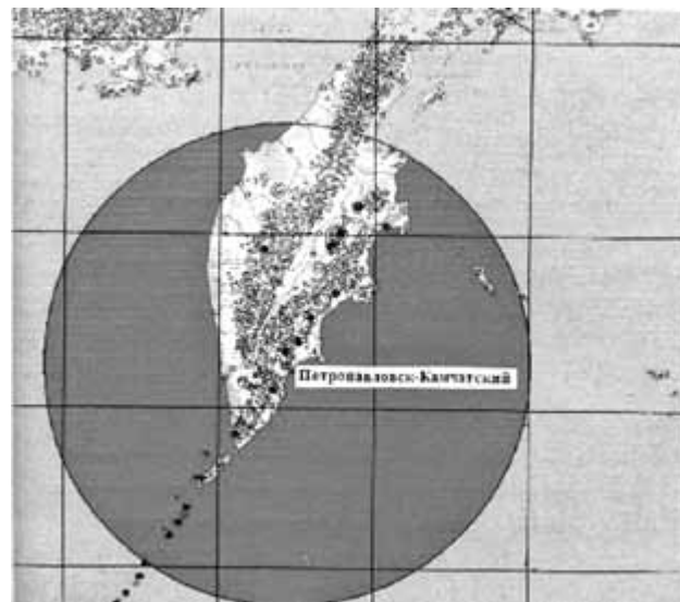
Рис.1. Рабочая зона передатчика НАВТЕКС, установленного в Петропавловске-Камчатском
